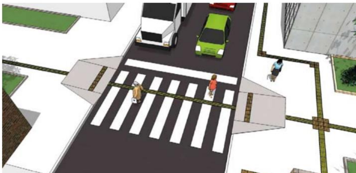
Figura 1 - Travessia acessível com piso tátil e guia rebaixada
